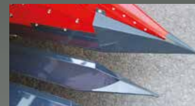
Las puntas de los divisores de cultivo en forma de cuchara son de acero resistente al desgaste.
