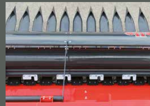
Las puntas de los divisores de cultivo en forma de cuchara son de acero resistente al desgaste.
